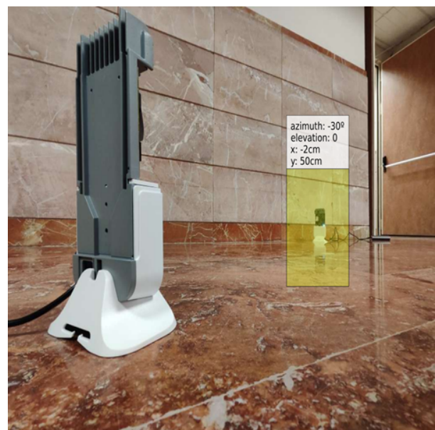
Expérience de localisation utilisant les prototypes. Le routeur de gauche est capable d'obtenir les coordonnées de celui de droite. Auteur : Pablo Picazo Martínez.
