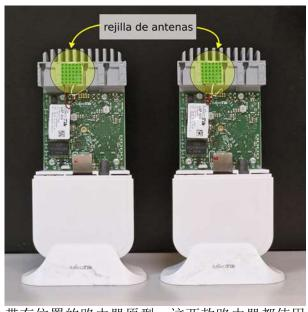
带有位置的路由器原型。这两款路由器都使用 高频发射的小型天线网格。
