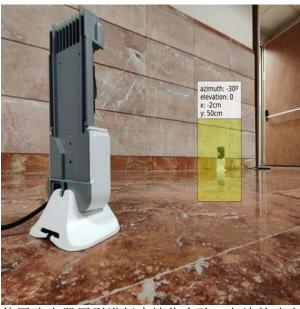
使用路由器原型进行本地化实验。左边的路由 器能够获取右边路由器的坐标。
