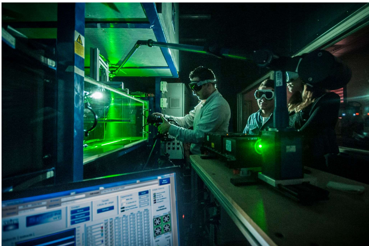
Expérience dans une soufflerie avec la technique de vélocimétrie pour l'imagerie de particules. Crédit : UC3M
