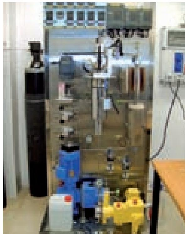
Figura 4. Planta a escala piloto de oxidación húmeda catalítica para el tratamiento en continuo de aguas residuales.
