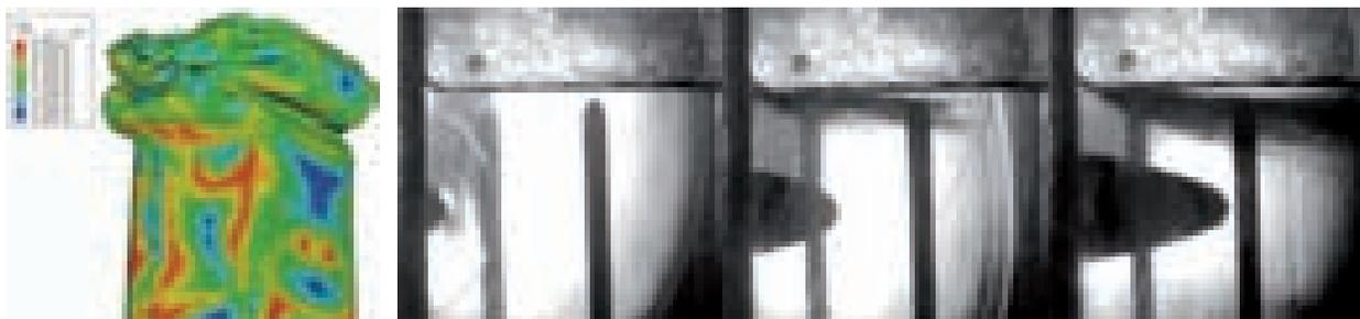
Izquierda: Simulación numérica del proceso de compresión por impacto de tubo de aluminio de estructura de vehículo. Derecha: Secuencia de impacto de proyectil en depósito de aluminio contenedor de fluido (600 m/s).
