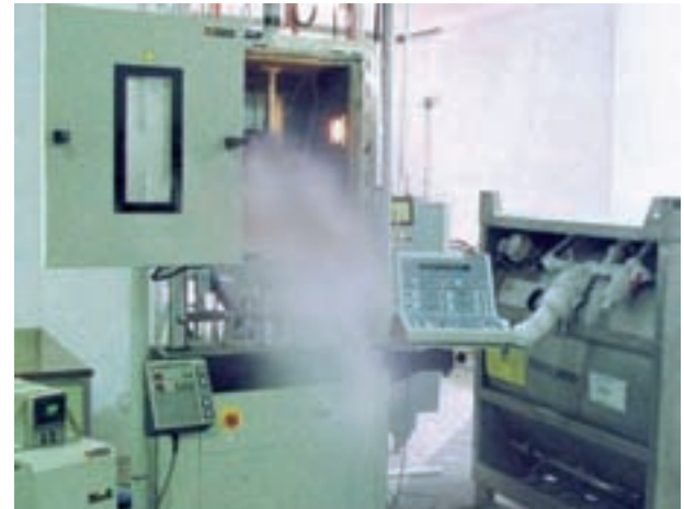
Figura 11. Ensayo criogénico realizado a -170\text{ }^{\circ}\text{C} para materiales utilizados en depósitos de gas natural licuado (GNL).
