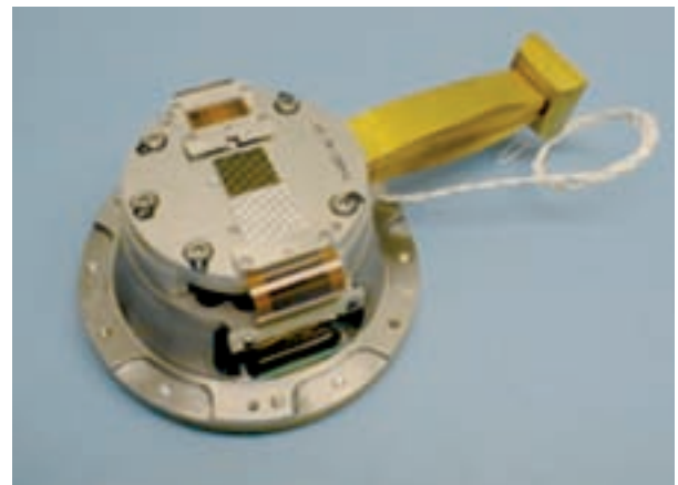
Figura 6. Montaje del plano focal de INTEGRAL-OMC con el modelo de CCD para pruebas colocado.
