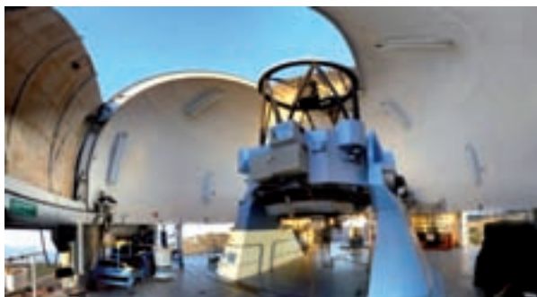
Figura 11. Telescopio nórdico NOT en la isla de la Palma al atardecer justo antes de empezar la observación astronómica. Se aprecia el espectrógrafo ALFOSC colocado en el foco cassegrain y las ventanas de ventilación en el perímetro de la cúpula.
