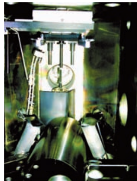
Figura 1. Sistema de depósito por evaporación en flujo modulado (MFD) en áreas de 10 \times 10 \text{ cm}^2 desarrollado y contruido en el CIEMAT. a) Vista exterior de la cámara; b) Vista interior de la misma.
