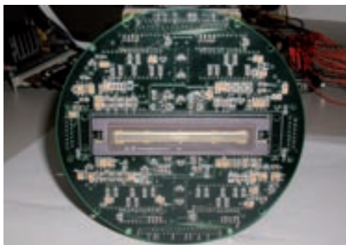
Figura 3. Plano focal con el detector lineal en el frontal.
