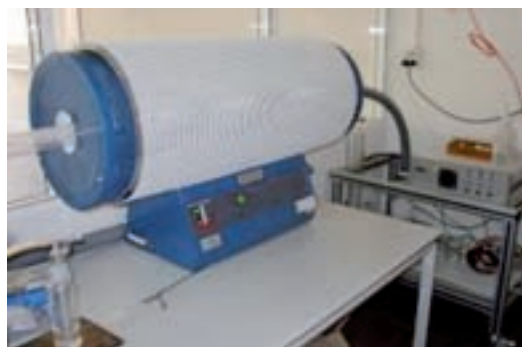
Figura 1. Atomizador Ultrasónico de 2.1MHz-Horno de alta temperatura 1.400°C.
