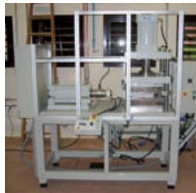
Figura 3. Sistema para deformación plástica severa mediante ECAP (Equal Channel Angular Pressing).
