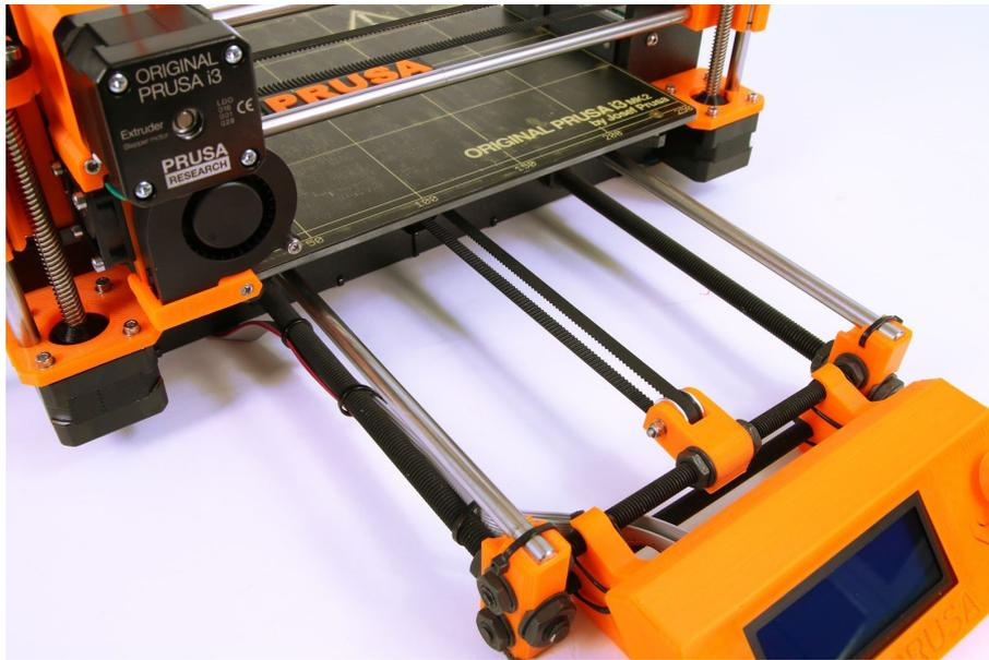
*Figura 37 - Una correa tensa en el eje Y debajo de la base calefactable*
