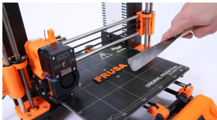
Figura 12. Retirando una pieza impresa de la superficie de impresión con una espátula
