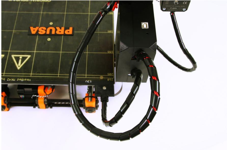
*Figura 39 - Cables que tienen que ser envueltos en la protección*
