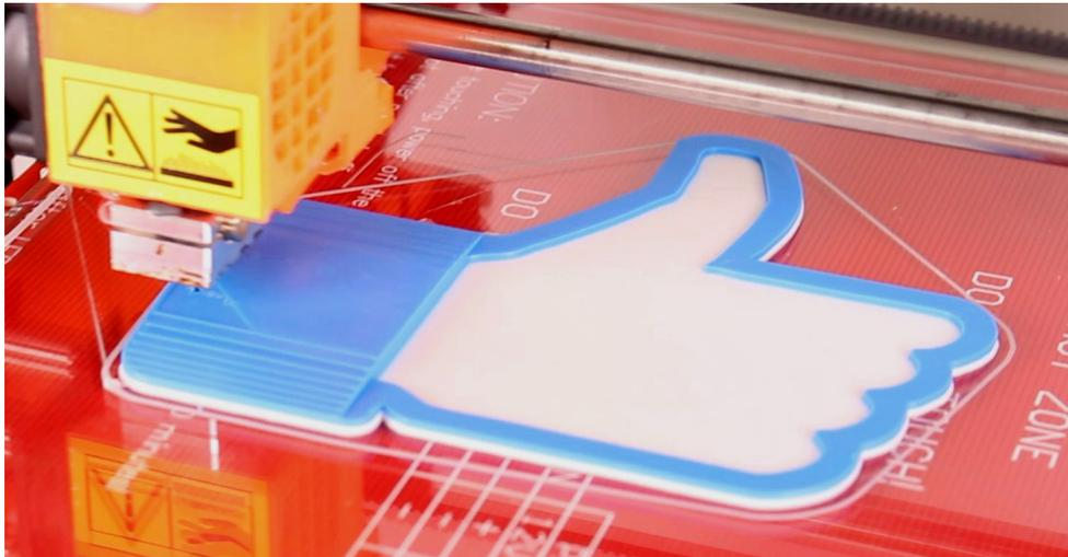
Figura 28 - Diseño multicolor impreso con ColorPrint
