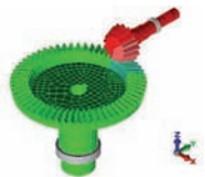
Engranaje cónico: simulación código algor
