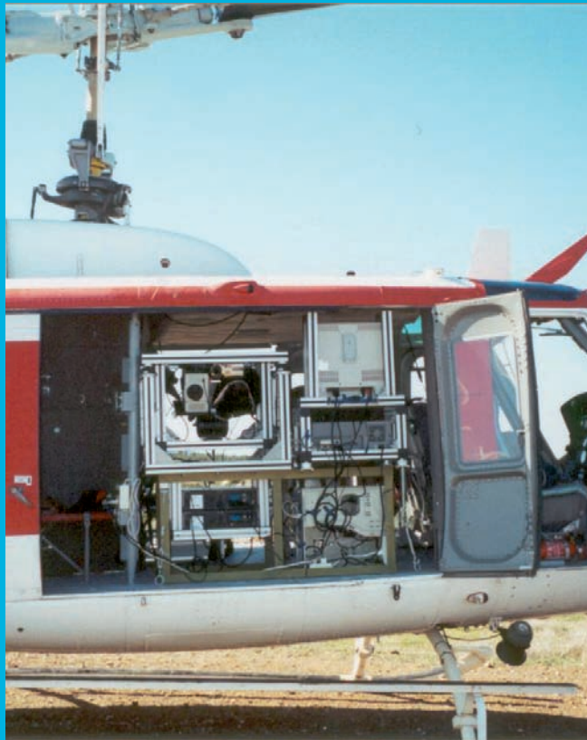
Investigación y Desarrollo de sistemas de imagen espectral IR embarcables para Teledetección Aerotransportada. Ayuda a la lucha contra los incendios forestales
