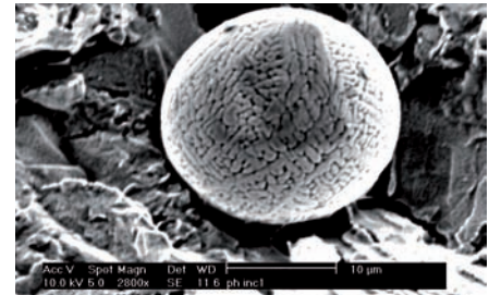
Partícula de un acero inoxidable 17-4 PH tratado por HIP (Compactación Isostática en caliente).
