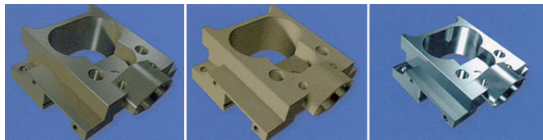
Compacto en verde, compacto en marrón y material sinterizado en un proceso de moldeo por inyección de polvos.
