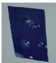
*Ensayo de adhesión y embutición profunda.*
