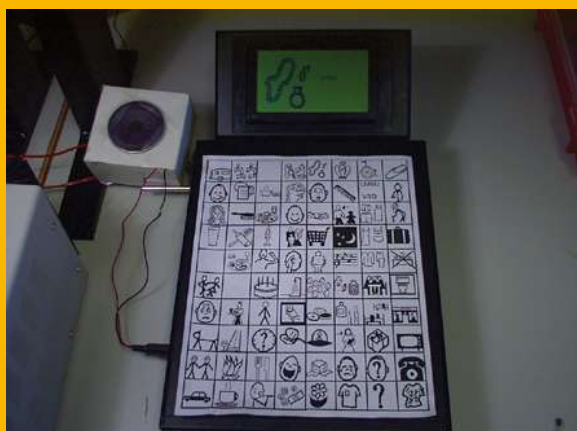
Comunicador programable y con refuerzo de voz basado en los lenguajes BLISS y SPC para personas con discapacidad mental severa.
