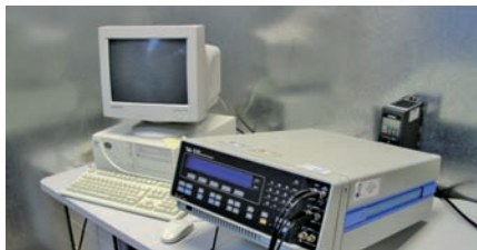
"Medida de Z(w)": Equipo de caracterización de la respuesta dieléctrica de materiales aislantes en el dominio de la frecuencia. Ancho de banda 0,1 uHz a 30 MHz
