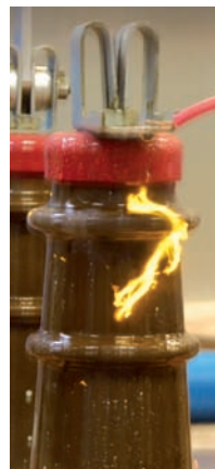
"Contorneo de aislador" y "Contorneo 2": Ensayos de tensión aplicada a un aislador de intemperie
