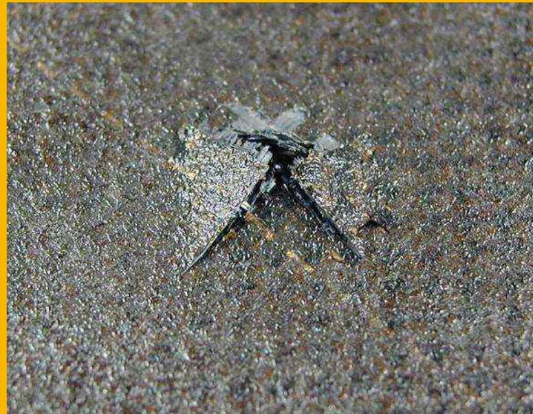
Simulación del impacto en laminado de fibra de carbono
