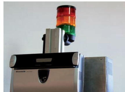
Cámara de iris para el reconocimiento biométrico
