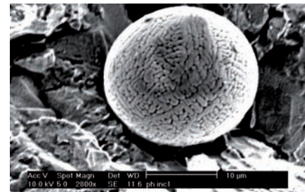
Partícula de un acero inoxidable 17-4 PH tratado por HIP (Compactación Isostática en caliente).
