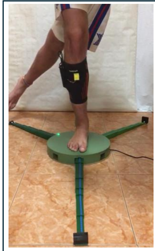
Figura: Sistema WI-YBT compuesto por plataforma con brazos extensibles en suelo y malla con sistema inalámbrico sobre pierna.
