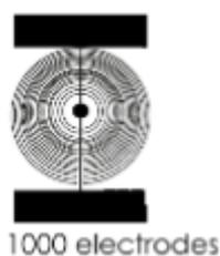
Fig. 2: Máscara de electrodos del diseño de lente con estructura de línea de transmisión actuando como divisor de tensión.
