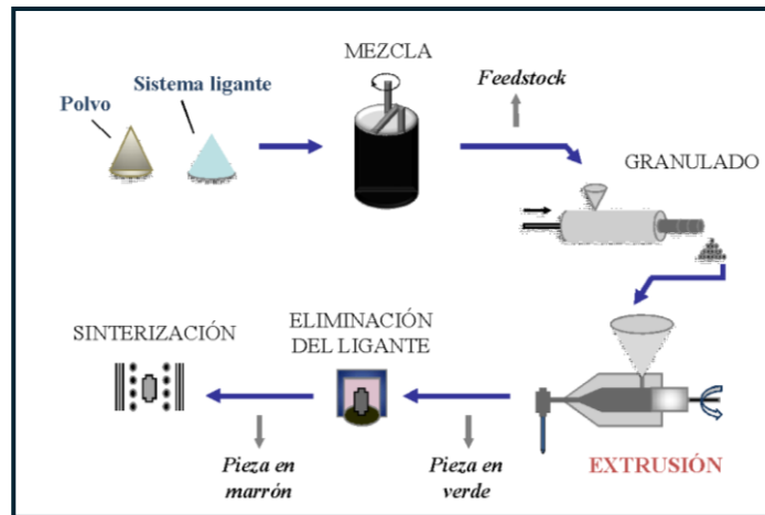
Representación esquemática del proceso de moldeo por extrusión de polvos (PEM)
