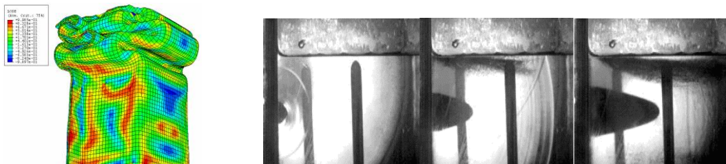
Izquierda: Simulación numérica del proceso de compresión por impacto de tubo de aluminio de estructura de vehículo. Derecha: Secuencia de impacto de proyectil en depósito de aluminio contenedor de fluido (600 m/s).
