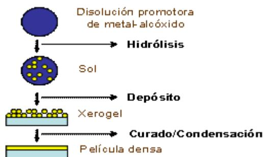
*Esquema del proceso de obtención de pretratamientos sol-gel*
