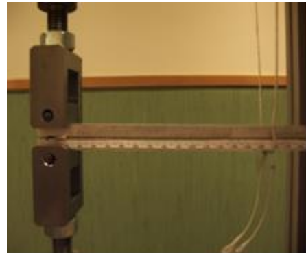
Ensayo DCB de dos placas de Aluminio pegadas
