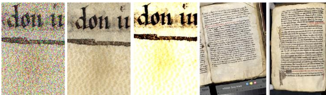
Degradación de la calidad en la digitalización de documentos: ruido, contraste, error de alineación, curvatura, etc.
