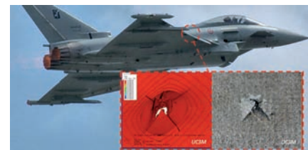
Simulación de un impacto de alta velocidad sobre un laminado de fibra de carbono.
